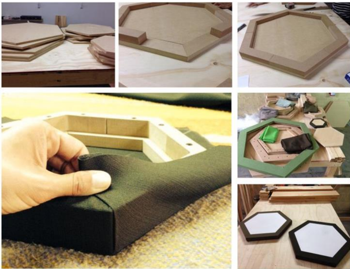
Proceso constructivo lampara plafón
